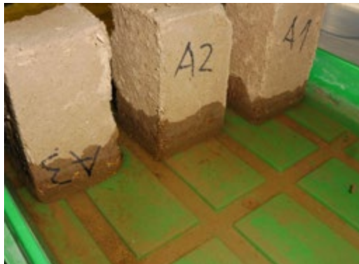
7. Laborversuch zur kapillaren Wasseraufnahmefähigkeit von Baustoffen
